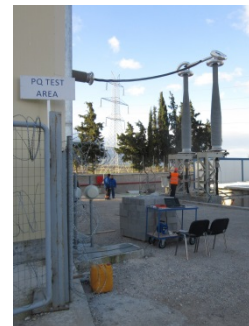
Die aufwändige Präqualifikationsprüfung wurde auf einem von der Hellenic Cables Group extra dafür gebauten Testfeld durchgeführt.
