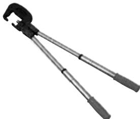
PFISTERER's offene Handpresszangen sind mit einem um 360° drehbaren C-förmigen Pressenkopf ausgestattet. Zur stufenlosen Längenverstellung der Teleskopgriffe wird der Griff nur durch eine Drehbewegung gelöst bzw. festgeklemmt.
