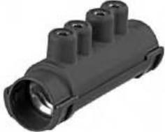
Isolierter Schraubverbinder für Niederspannungskabel mit isolationsdurchdringenden Kontakten. Die Schraubenkonstruktion gewährleistet, dass der Leiter während der Montage nicht beschädigt wird. Die Klemme ist so gestaltet, dass während des gesamten Montageablaufes immer ein Berührschutz nach IP2X gegeben ist und auch keine Kurzschlussgefahr besteht.
