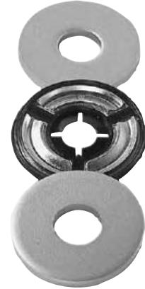
mit integriertem Adapter für Schraube M12 - M16 und 2 Stahlscheiben für Flachanschlüsse und Verbindungen in Freiluft-Schaltanlagen und Innenraum-Anlagen.
